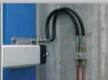
Conexión al bloque de derivación con racores de 4 vías
